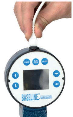
Lade-/Datenkabel (Micro-USB) in Steckerbuchse am Prüfstandskopf einstecken
