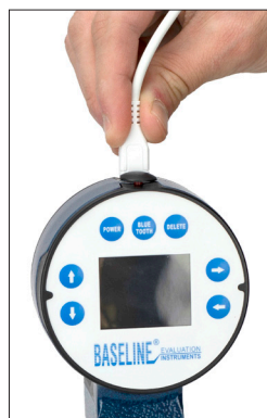
Chargez le câble de charge/données (micro USB) dans la prise située sur la tête du dynamomètre.
