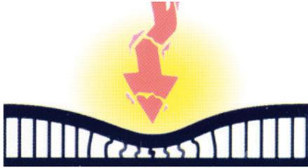
Le noyau de la protection est constitué d'une structure en nid d'abeilles légère composée de cellules remplies d'air. En cas de choc, ces cellules sont comprimées et agissent comme de petits amortisseurs. La puissance du choc est ainsi répartie et absorbée !
